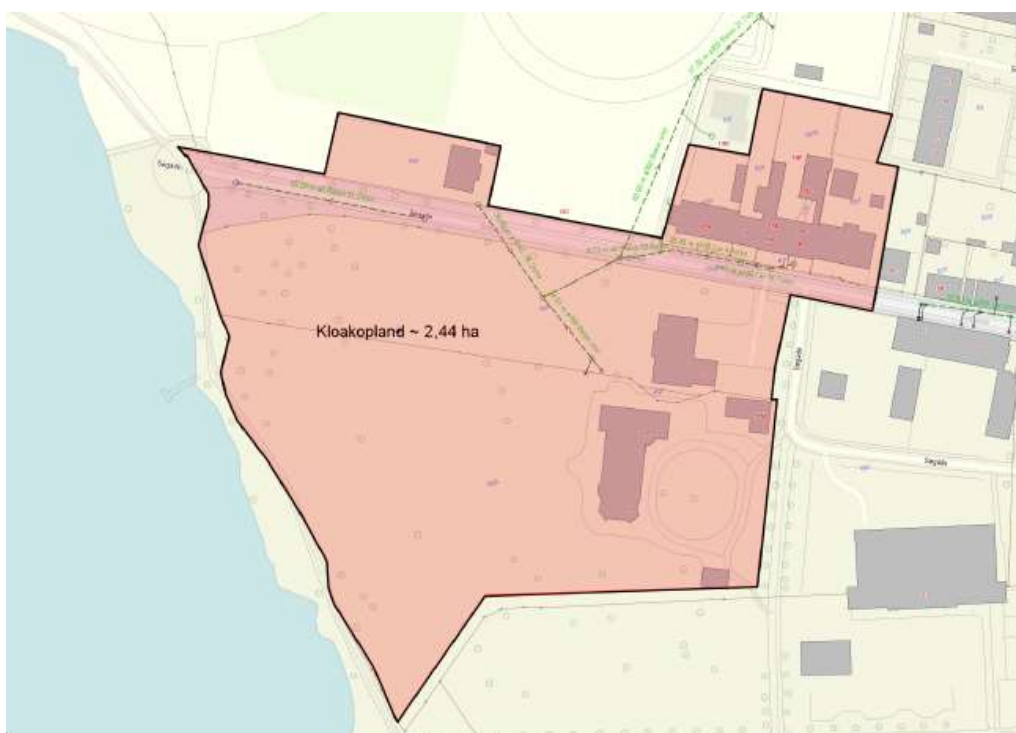
Figur 1. Det nye påtænkte kloakopland. Grøn ledning = Fælleskloak.
