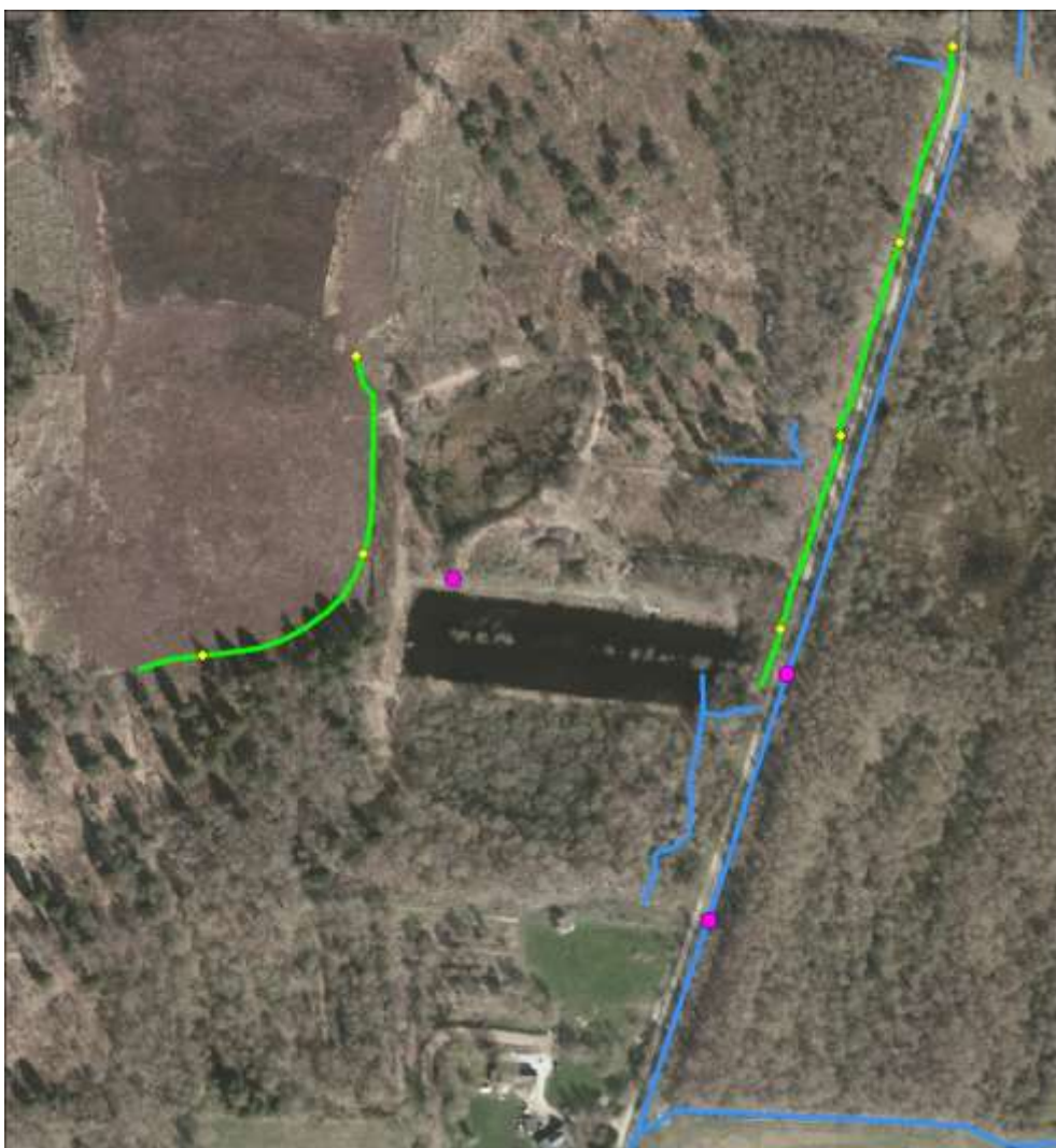
Figur 2. Forløbet af membranerne i Verup Mose vist med grøn streg med gule stationeringsmærker per 100 m og med de nye spuns vægge markeret med lilla cirkler samt
