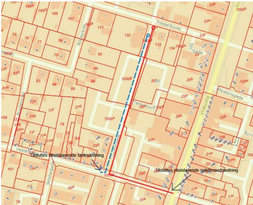
Figur 3. Planlagt ny ledningsføring. Rød tyk streg er spildevand og blå stippet streg er regnvand.
