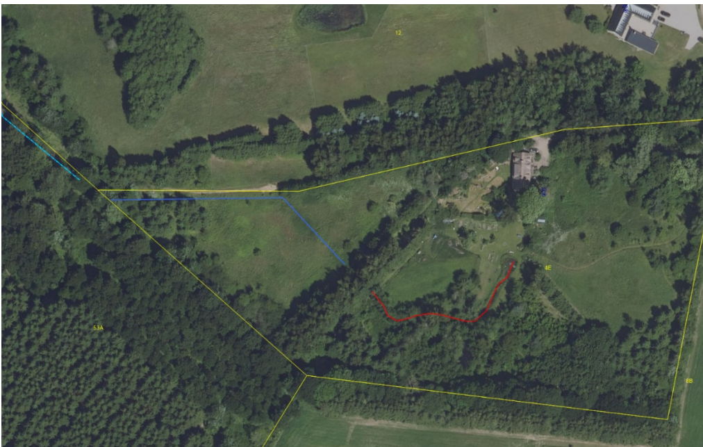
Figur 1: Rød linje viser den strækning, som rørlægges. Blå linje viser den strækning, som åbnes. Stiplet lyseblå linje viser den vandløbsstrækning nedstrøms projektområdet, som er omfattet af naturbeskyttelseslovens § 3.
