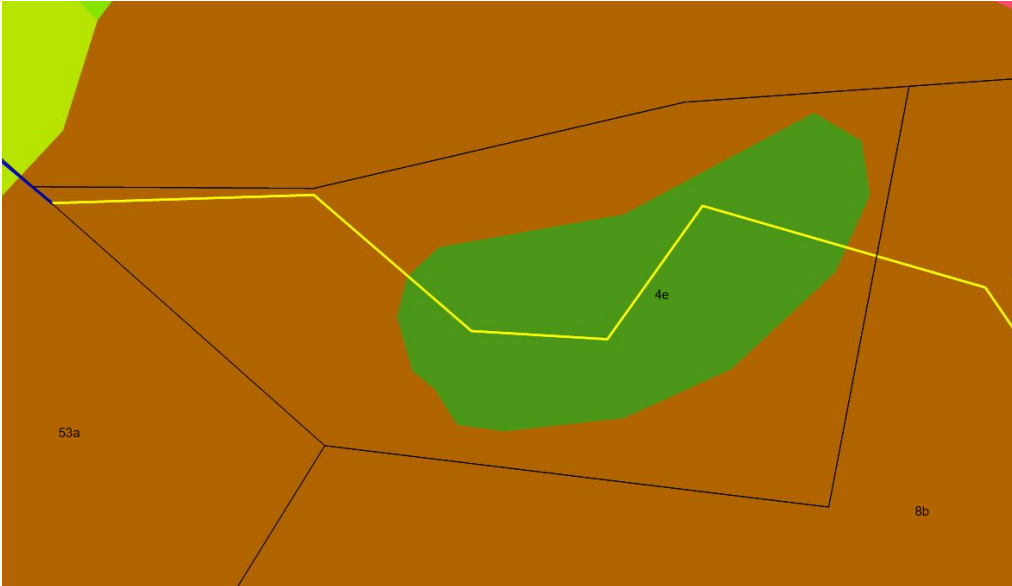
Figur 2: Det tidligere og nuværende rørlagte forløb er vist med gul linje. Den genåbnede strækning løber igennem en lomme af ferskvandstørv (grøn farve) i et område der ellers er præget af moræneler (brun farve).
